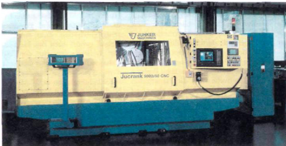
图1：高速CNC磨削中心，带有大量的测量装置，用于通过一次装夹对曲轴进行柔性的再磨削
