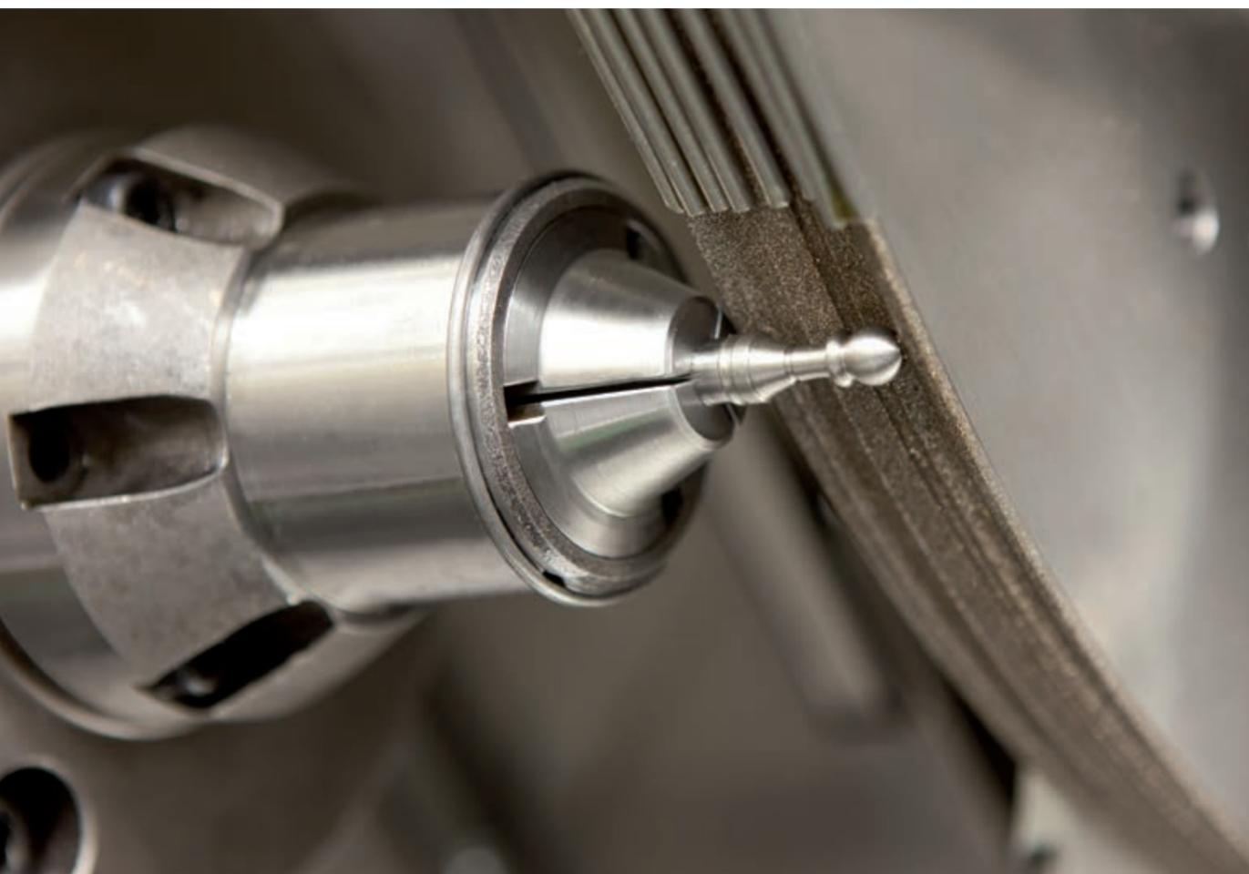
Das GRINDSTAR Maschinenkonzept ersetzt die Drehbearbeitung durch abrichtfreies Hochgeschwindigkeits-Einsteichschleifen, womit insbesondere bei der Bearbeitung von Großserien enorme Einsparpotenziale realisiert werden können.
