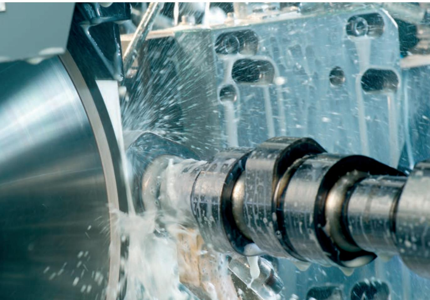
Die Außen- und Innenrundscheifmaschinen der Baureihe JUCAM begeistern mit präzisen Schleifergebnissen in einer Einspannung. Durch die Steuerung mit Learning Function – bei der nahezu alle Störgrößen kompensiert werden – erhalten Nockenwellen, Nockenstücke und Einzelnocken den perfekten Schliff. Die jahrzehntelange Erfahrung im Nockenschleifen, die vielen Sonderlösungen und die daraus entstandene Lösungskompetenz überzeugen weltweit Motoren- und Pumpenhersteller.
