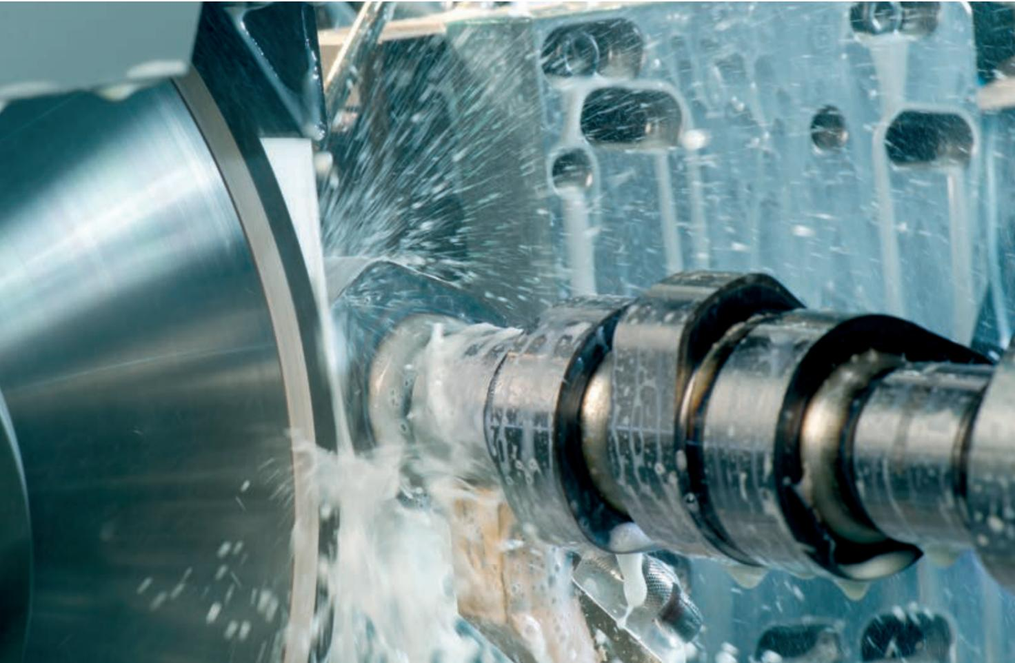
Die Lean Selection cam ist ein wirtschaftliches und flexibles Maschinenkonzept für die Nockenwellenbearbeitung in allen Seriengrößen. Am Schleifspindelstock können bis zu zwei Hochleistungs-Schleifspindeln angebracht werden und durch das Schwenken der B-Achse kann das Werkstück in einer Einspannung vor- und fertiggeschliffen werden. Die CBN-Unrundschleifmaschine Lean Selection cam überzeugt durch eine benutzerfreundliche Bedienung, minimale Prozesszeiten und eine hohe Verfügbarkeit.
